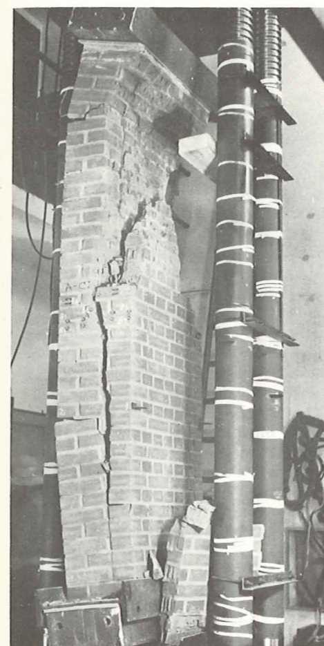
Fig. 4. Brud i en excentrisk belastet 1 1/2 stens mur i CM.
